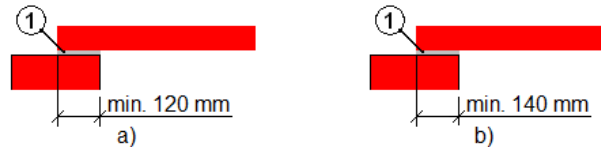
Obr. 1 Minimálna dĺžka uloženia keramického prekladu ATLAS 11,5
