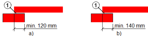
Obr. 1 Minimálna dĺžka uloženia keramického prekladu ATLAS 11,5
